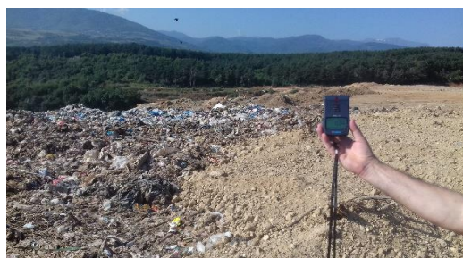
Слика бр.VI-5 и бр. VI-6 - Мерење со апарат за јонизирачко зрачење
